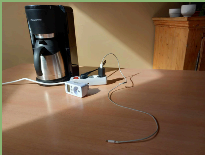
Mesure des consommation Utilisation de wattmètres
